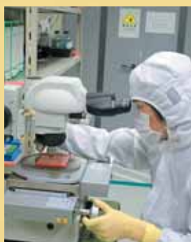
微細加工されたガラス部品の検査を行う山下さん
