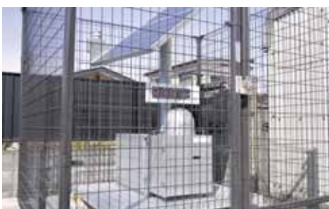
柴田町役場駐車場に設置された可搬型モニタリングポスト 測定値がリアルタイムで表示されます
