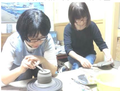
高台を削り出したり形を整える仕上げの工程
