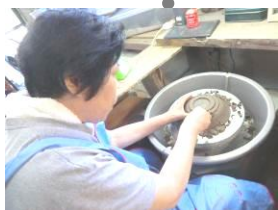
高台を削り出したり形を整える仕上げの工程
