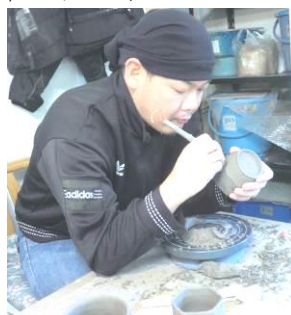
高台を削り出したり形を整える仕上げの工程
